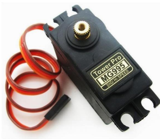
3.2 Сурет –TowerPro MG995 Сервопривод үшін ерекшелік:
